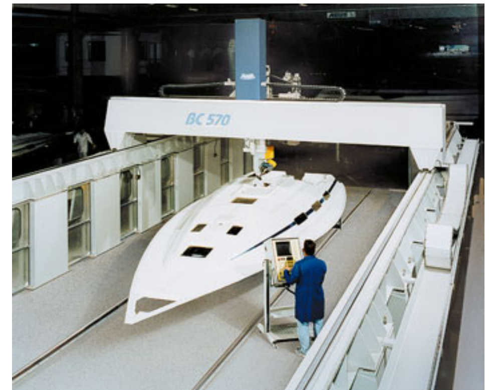
Anwendung im Schiffsbau: GFK-Bearbeitung eines Bootsdecks
